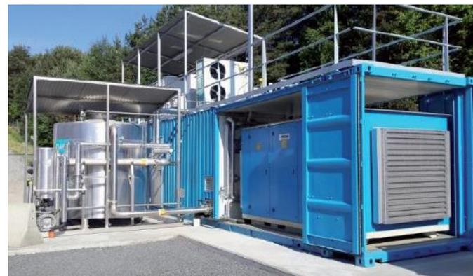
Instalación membranas. 400 m<sup>3</sup>/h biogás. DMT-Carborex
