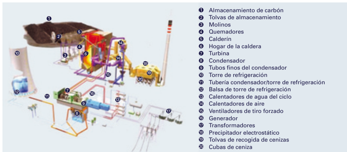
Figura 1.13. Central térmica convencional de carbón. Fuente: Gas Natural Fenosa (consultado en 2016).
