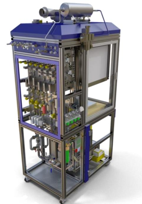
Banco de ensayos de testeo de stacks SOFC (EBZ)
